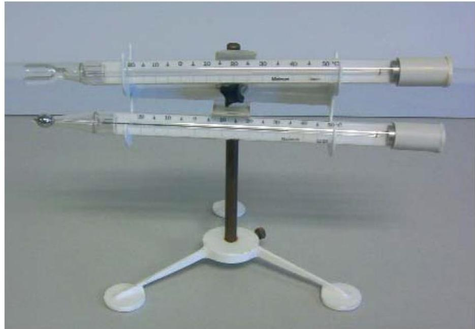
Figura 3.1. Distintos termómetros de máxima y mínima.
