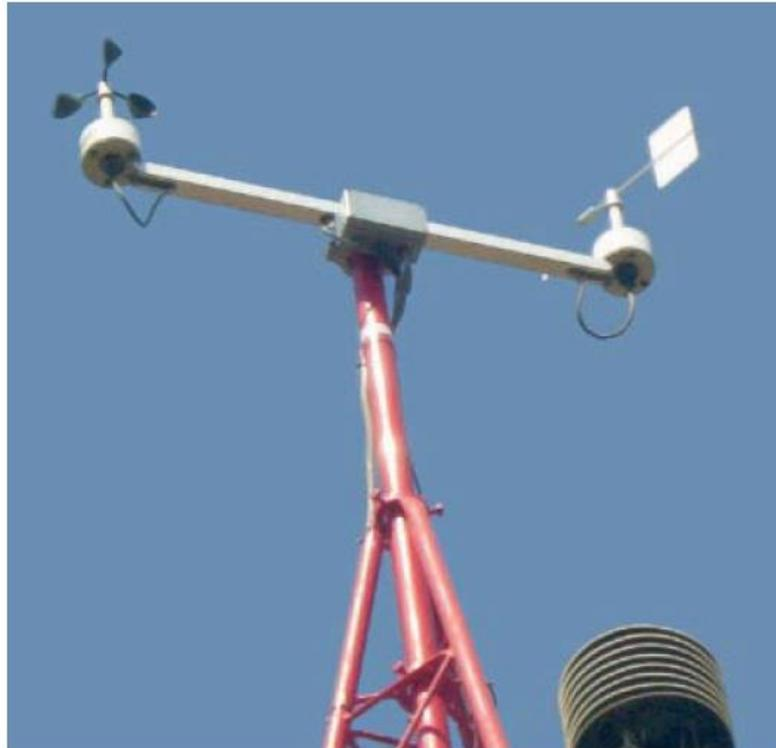
Figura 3.4. Anemómetro de cazoletas.
